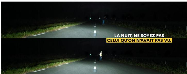
D'après une expérience menée par la Sécurité routière chez UTAC, les piétons vêtus d'une tenue rétro réfléchissante sont visibles de nuit dans les phares d'une voiture à 44 mètres et les cyclistes à 63 mètres vs respectivement 28 mètres et 35 mètres avec une tenue sombre
